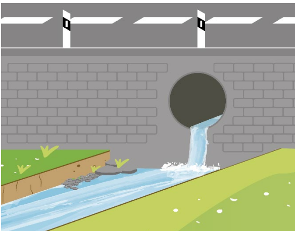
Vorher: Rohrdurchlass mit Absturz, zu geringer Wassertiefe und fehlender Substratauflage
