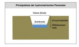
Profiltiefe (Rechnerische Ermittlung des Verhältnisses zwischen Einschittstiefe zur Oberen Breite und Klassifizierung nach LANUV-NRW 2018)
