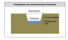
Profiltiefe (Rechnerische Ermittlung des Verhältnisses zwischen Einschittstiefe zur Oberen Breite und Klassifizierung nach LANUV-NRW 2018)
