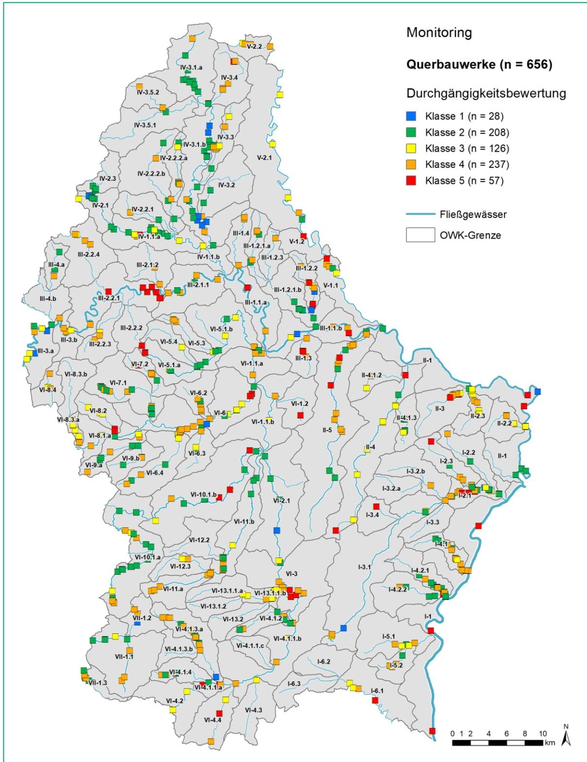
Ergebnisse der Detailerfassung der „Querbauwerke“ im Rahmen der Strukturgütekartierung: Gesamtbewertung der Durchgängigkeit der Einzelbauwerke<sup>1</sup>
