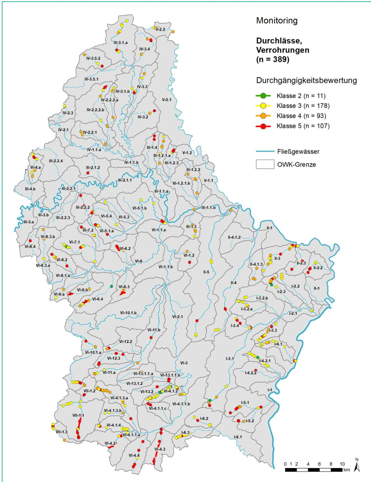
Ergebnisse der Detailerfassung der „Durchlässe / Verrohrungen / Überbauungen“ im Rahmen der Strukturgütekartierung: Gesamtbewertung der Durchgängigkeit der Einzelbauwerke<sup>2</sup>
