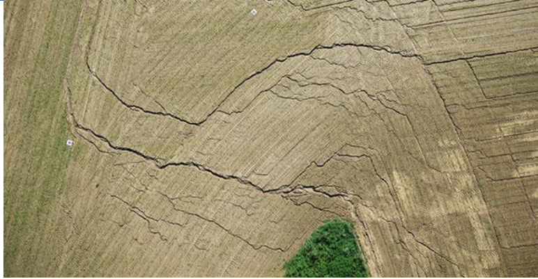
Abbildung 2-4: Beispiel einer Situation mit Erosion von Feinsedimenten aus landwirtschaftlichen Flächen ( https://hoal.hydrology.at/research-in-the-hoal/erosion/ )
