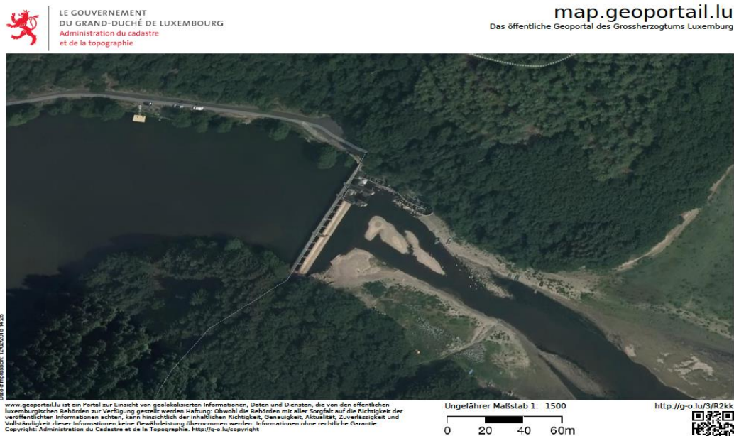
Abbildung 8-12: Vorstaumauer Pont Misere mit linksufrigem Fischaufstieg (Quelle: Geoportal)
