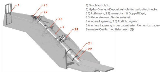
Abbildung 8-34: Schematische Darstellung der Funktionsweise einer Doppelrohrschnecke ( www.hydroconnect.at , Zeiring et al. 2017)
